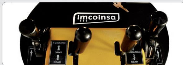
Panel de mando integral Dirección de avance, vibración y mando acelerador
